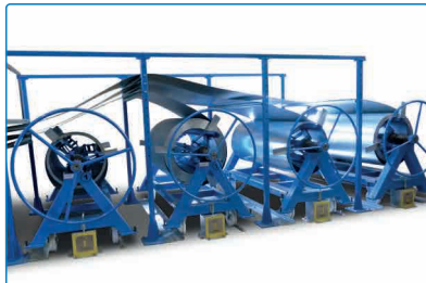
Bis zu 6 Abrollhaspeln (5 oder 7 Tonnen)
